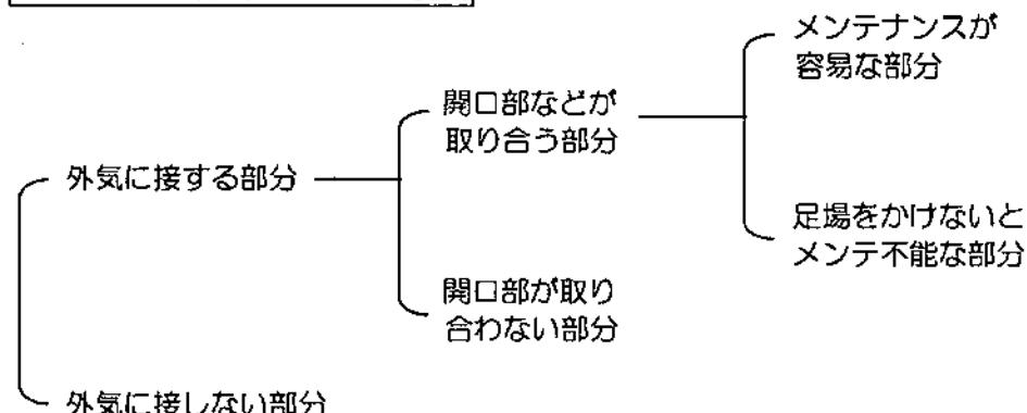
一つの建物を一つの工法で外断熱化することは、施工監理の面から有効な方法といえます。一方で、上図に示したような外壁パターンに応じて最適な工法を検討し、その方法を自ら考えることにより、例えば、外装材や下地として地域資源の活用や地域生産力を積極的に導入していくこともできます。
