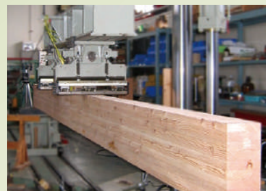
実大材の曲げ強度試験
