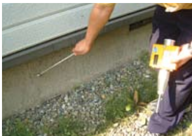
打診棒による仕上げ材の浮きの確認
