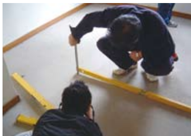
床の傾斜測定(傾斜計の利用)
