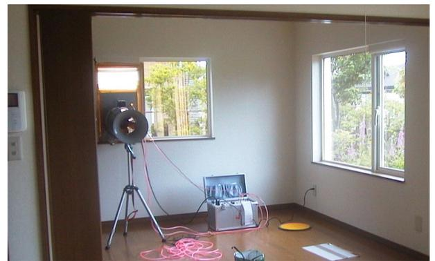
気密測定により、どの程度の気密性能（隙間の大きさ）があるのかを確認することができます。
