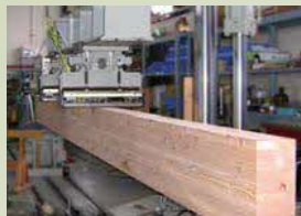
実大材の曲げ強度試験
